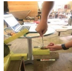
Gambar 3.15 Pemasangan sensor berat
