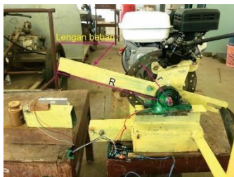
Gambar 4.3 Notasi lengan beban Dinamometer rem cakram dan lengan gaya pengereman
