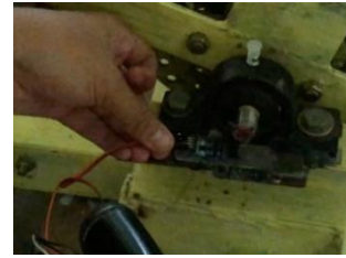
Gambar 3.14 Pemasangan sensor kecepatan LM 393
