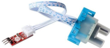
Gambar 4 Sensor Kekeruhan Air
